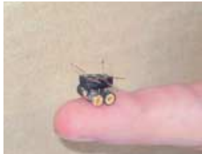
En uzun boyutu 10 mm'den daha küçük olan bir mikro robot mekanizması.
