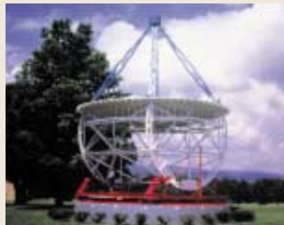
Grote Reber'in 9 metrelik radyo anteni NRAO'nun Green Bank yerleşkesinde yenilenmiş biçiminde sergilenmektedir. Bu anten çanak biçiminde yapılmış dünyanın ilk radyo teleskobudur.
